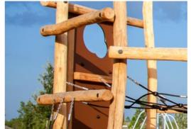
Pannello d'arrampicata in compensato. I pannelli per arrampicata sono realizzati in multistrato di spessore 21,5 mm in legno di ontano e pino. Entrambi i lati sono coperti da 2 strati di film fenolico con motivo a rete antiscivolo. Tutti i taglienti sono sigillati con vernice per garantire una lunga durata.
