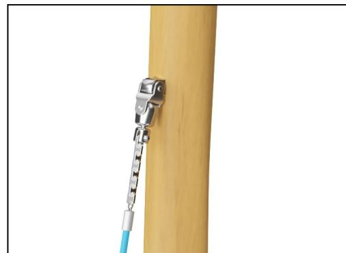
Les supports de balançoire sont constitués de supports en acier inoxydable et peuvent se déplacer sur deux axes. Les roulements de bride sont enrichis en silicone pour rendre la suspension sans entretien. La connexion à la corde est réalisée avec une chaîne en acier inoxydable.
