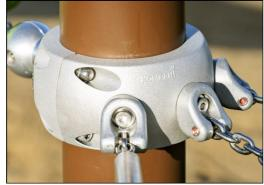
Corocord 智能夹在每个细节上都经过精心设计, 以确保高品质铝材料的卓越灵活性。智能夹用四 个钢螺栓固定在柱子周围。未使用的连接点用 PA 盖关闭。
