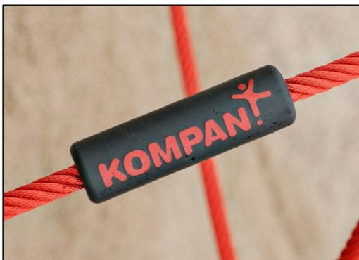
Les cordes Corocord d'un diamètre de 19 mm ou plus, sont des cordes spéciales de type « Hercules » dotées de torons de six brins d'acier galvanisé. Chaque toron est enveloppé hermétiquement dans du fil PES. Les cordes sont résistantes à l'usure et au vandalisme et peuvent être remplacées sur place si nécessaire.
