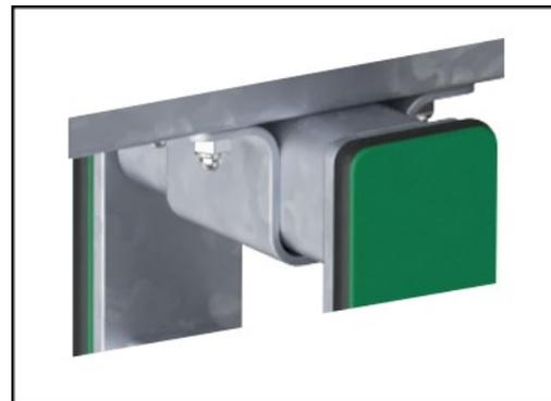
Il movimento di oscillazione è controllato da un elemento a molla di torsione in gomma graduata per impieghi gravosi.
