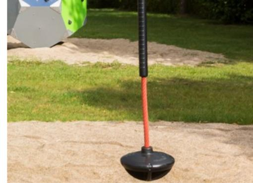
El asiento de diseño especial está hecho de un inserto de acero inoxidable cubierto con una capa suave de caucho PUR. El asiento tiene una prueba de impacto para cumplir con todos los estándares mundiales de juegos y la cuerda tiene un asidero ergonómico de 60 cm de largo moldeado en mango de goma PUR.
