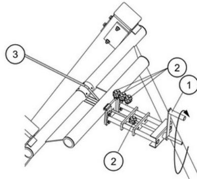
El cable de acero 3 está tensado por un dispositivo de diseño especial. Al girar el mango 1, el cable de acero se puede tensar de acuerdo con las instrucciones de forma segura. Después de tensar el cable se bloquea con tres abrazaderas 2. El dispositivo tensor también se puede utilizar para el ajuste durante las inspecciones anuales.
