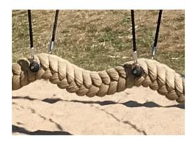
摆锤的绳索由椰子风格的聚丙烯 (PP) 绳索制成, 14x14cm 方形造型。椰子绳的末端用钢夹封闭,并用胶粘的可收缩管密封。将绳索末端的最后 10 厘米切开,以制成具有保险杠功能的流苏,以满足全球安全要求。
