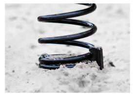
Le molle KOMPAN sono realizzate con acciaio per molle di alta qualità secondo EN10270. Le molle vengono pulite mediante fosfatazione prima di essere verniciate con un primer epossidico e un rivestimento in polvere di poliestere come finitura superiore. Le molle sono fissate da esclusivi raccordi anti pizzico per la massima sicurezza e lunga durata.
