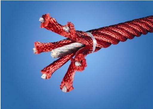
Seile aus UV-stabilisierten PES-Litzen mit innerer Stahlseilverstärkung. Das Polyestergerüst besteht aus +95% Post-Consumer-Materialien und wird induktiv auf jede Litze aufgeschmolzen. Damit sind die Seile besonders beständig gegenüber Abnutzung und Vandalismus und können jederzeit vor Ort ausgetauscht werden.
