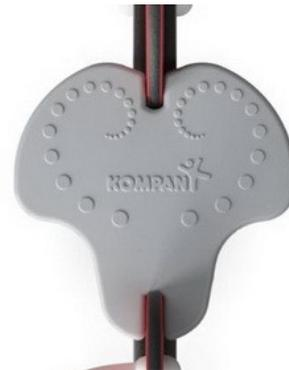
El asiento está hecho de un inserto de PP moldeado con una capa exterior suave de caucho TPE. El caucho TPE tiene una buena absorción de impactos y garantiza una solución duradera.
