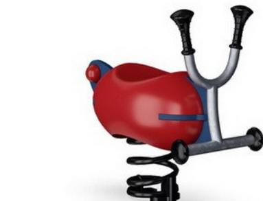
KOMPAN Federn bestehen aus hochwertigem Federstahl nach EN 10270-1. Die Federn werden durch Phosphatierung gereinigt, bevor sie mit einer Epoxid-Grundierung und Polyester-Beschichtung überzogen werden. Die Federn werden mit speziellen Klemmschutz-Elementen angebracht, um für höchste Sicherheit und eine hohe Lebensdauer zu sorgen.
