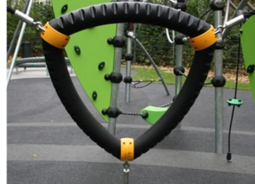
Galaxy-Dreiecksrahmen mit weicher PUR-Beschichtung und Eckwinkeln aus Perlon (PA6). Der Rahmen besteht aus pulverbeschichtetem Stahl und verfügt über integrierte Aufhängungspunkte in den Ecken. Die großen Dreiecksrahmen bestehen aus 18 mm starken EcoGrip®. Die TPE-Oberflächenbeschichtung sorgt für einen Anti-Rutsch-Effekt.
