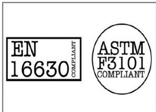
Tous les produits de remise en forme KOMPAN sont conformes aux normes pour l'entraînement physique de plein air ASTM F3101 et EN16630. Les tests de charge sont effectués sous forme d'essai statique en ajoutant des facteurs dynamiques ainsi que des facteurs de sécurité à une charge spécifiée de 78 kg par utilisateur. Un produit destiné à un utilisateur est chargé à 420 kg.
