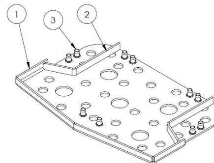
Une plaque d'acier en carbone galvanisée de 5 mm est moulée à l'intérieur du SBR afin d'offrir une stabilité optimale et d'optimiser le montage des marches sur le cadre.
