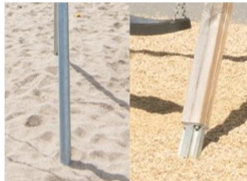
Die Pfosten der A-Rahmen-Schaukeln sind erhältlich mit Bodenverankerung in einer Tiefe von 60 cm oder 90 cm. Die feuerverzinkten Stahlbeine werden direkt in den Boden verankert. Die Kiefernholzpfosten werden durch feuerverzinkte Stahlfüße gestützt.
