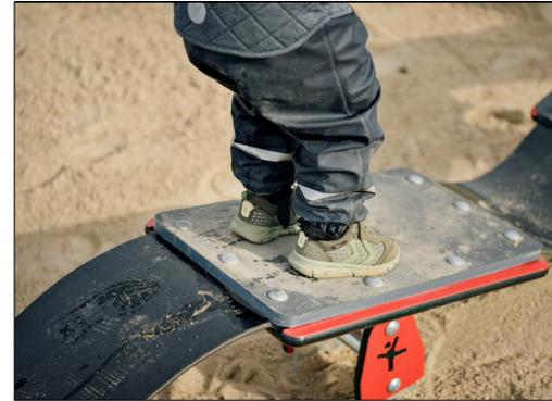
Die beiden zentralen Platten des Wave Steppers bestehen aus Ekogrip®-Platten, die aus einer 15 mm dicken PE-Basis mit einer 3 mm dicken Deckschicht aus weichem Gummi mit Anti-Rutsch-Effekt bestehen.
