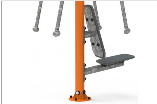
Die Stahlpfosten sind aus Ø101,6 x 2,0 mm bandverzinktem Stahlrohr gefertigt. Die Pfosten sind pulverbeschichtet, Korrosionsklasse C3 nach ISO12944-2.
