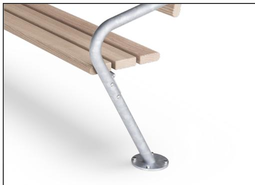
Le superfici in acciaio sono zincate a caldo internamente ed esternamente con zinco senza piombo. La zincatura ha un'ottima resistenza alla corrosione in ambienti esterni e richiede poca manutenzione. Le parti in acciaio verniciato sono zincate a caldo prima della verniciatura a polvere.
