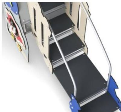
Alle Böden bestehen aus HPL-Hochdrucklaminat mit einer Stärke von 17,8 mm und rutschfester Oberflächenstruktur nach EN 438-6. Die KOMPAN HPL-Böden sind unter allen Wetterbedingungen äusserst verschleissfest.
