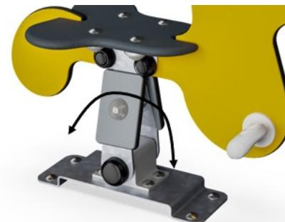
Le mouvement de bascule sur l'axe est réalisé par un élément de ressort de torsion ROSTA robuste. L'élément ROSTA est silencieux et nécessite peu d'entretien.
