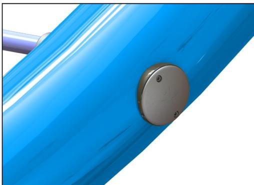
La cuerda se fija al poste de acero grande mediante una solución de tensión única diseñada por KOMPAN. Consiste en casquillos de nailon interior y exterior (PA6) que guía la cuerda a una parte exterior de aluminio roscada que aprieta la cuerda.
