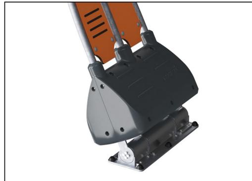
Die Schaukelbewegung vor und zurück wird durch ein hochbelastbares, skaliertes Doppelgummi-Torsionsfederelement gesteuert. Das Gummielement gewährleistet eine sichere Bewegung und reduziert die Geschwindigkeit in Richtung der Turmplattformen. Die Basisabdeckung ist aus geformtem PE-Material mit hoher Schlagfestigkeit hergestellt.
