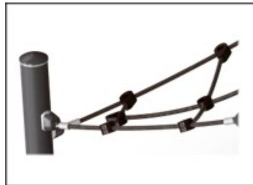
座椅的绳索环由单股编织的 16 毫米 PES 绳索制成。PES 具有很高的强度，并具有极好的耐磨性和抗紫外线辐射性。绳环通过尼龙（PA6）连接头连接。
