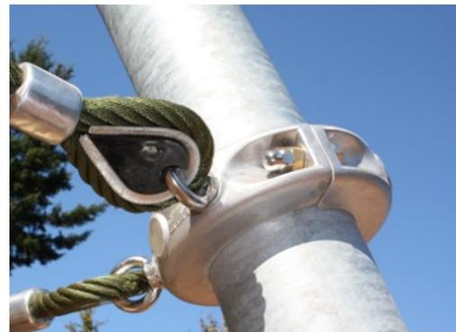
Las abrazaderas de aluminio Corocord se utilizan como conectores entre los postes de acero y la cuerda. Dos piezas de fundición de aluminio están atornilladas juntas. La altura de las abrazaderas es, por lo tanto, variable.
