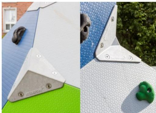
Soportes de esquina fundidos a presión de aluminio sin plomo de alta calidad. Los soportes de esquina tienen bordes muy redondeados y tornillos de acero inoxidable avellanados. Para entornos soleados, el soporte de esquina puede suministrarse con un recubrimiento en polvo opcional que reduce la absorción de calor de los soportes.
