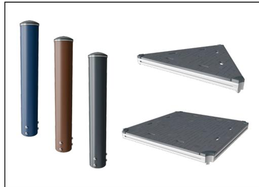
Die Hauptpfosten sind aus hochwertigem, vorverzinktem Stahl mit pulverbeschichteter Oberfläche hergestellt. Die Pfostenoberseiten sind mit Kappen aus UV-stabilisiertem Polyamid PA6 verschlossen. Die grau gefärbten, spritzgussgeformten Bodenplatten bestehen zu 75% aus recyceltem Fischernetzen (PP-Material), und haben ein rutschfestes Muster und eine strukturierte Oberfläche.
