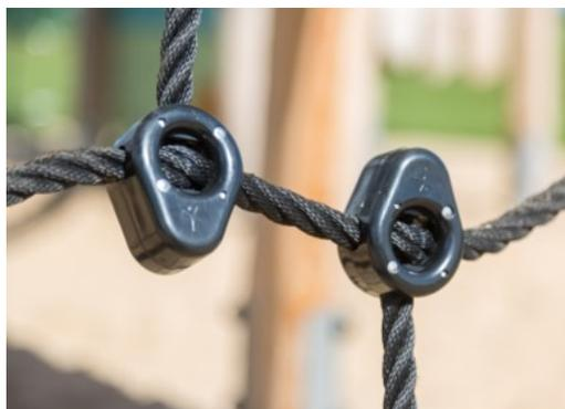
Des cordes fabriquées avec des torons PES résistants aux UV et dotées d'un câblage renforcé avec armature interne en acier. Le fil de polyester est réalisé avec plus de 95 % de matériaux post-consommation. Il est fondu par induction sur chaque toron, ce qui lui offre une excellente résistance à l'usure.
