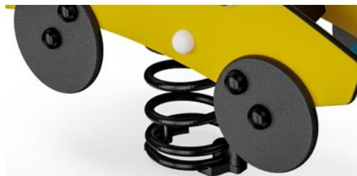
Le molle KOMPAN sono realizzate con acciaio per molle di alta qualità secondo EN10270. Le molle vengono pulite mediante fosfatazione prima di essere verniciate con un primer epossidico e un rivestimento in polvere di poliestere come finitura superiore. Le molle sono fissate da esclusivi raccordi anti pizzico per la massima sicurezza e lunga durata.
