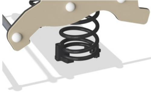
KOMPAN Federn bestehen aus hochwertigem Federstahl nach EN 10270-1. Die Federn werden durch Phosphatierung gereinigt, bevor sie mit einer Epoxid-Grundierung und Polyester-Beschichtung überzogen werden. Die Federn werden mit speziellen Klemmschutz-Elementen angebracht, um für höchste Sicherheit und eine hohe Lebensdauer zu sorgen.
