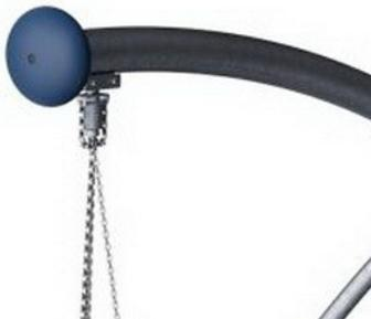
Speziell entwickelte 360°-Schaukelaufhängungen aus Edelstahl mit Anti-Überschlag-Funktion. Die Aufhängungen sind dauergeschmiert und versiegelt. Das Aufhängungssystem ist mit einer Sicherheitskette ausgestattet, um das Herunterfallen der Schaukelaufhängung bei Beschädigung zu verhindern.
