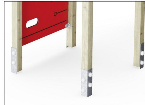
Die Pfosten der Haupttürme sind mit feuerverzinkten Stahlfüssen erhältlich. Die Stahlfüsse heben die Pfosten 20 mm von der Grundfläche an, sodass Kontakt mit dem Oberflächenmaterial verhindert wird.
