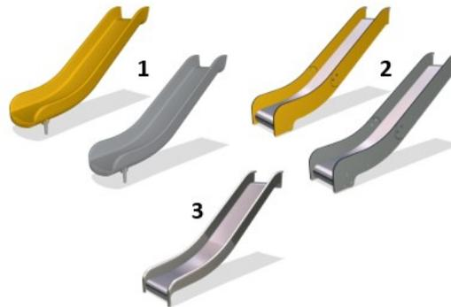
Rutschen sind in drei Materialausführungen erhältlich: gegossene, stückgeformte PE-Rutschen, Kombination aus EcoCore™ Rutsche und Edelstahlbett (t = 2 mm) oder Edelstahlrutsche (AISI 304, t = 2 mm).
