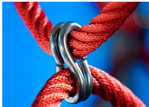
Corocord“S”扣在 Corocord 产品中作为通用连接。用特殊的液压机将带有圆形边缘的 8mm 不锈钢条压在绳索周围，使其成为理想的连接部件。其安全、耐用且防破坏，适用于攀爬网络游戏结构中的典型游戏运动。
