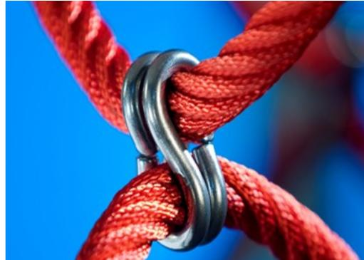
Die Corocord-S-Klemmen sind universelle Verbindungselemente aus rostfreiem Edelstahl mit einem Durchmesser von 8 mm. Die Klemmen sind abgerundet und das gesamte Bauteil wird mit hydraulischen Spezialwerkzeugen auf das Seil gepresst. Daher können die Klemmen mit herkömmlichen Werkzeugen nicht entfernt werden.
