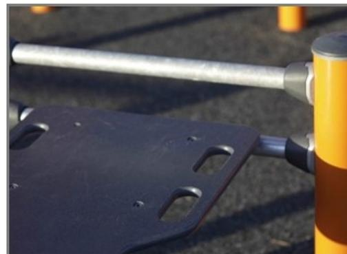
La superficie está hecha de paneles Ekogrip compuestos de polietileno de 15 mm con una capa superior de caucho termoplástico de 3 mm. Los paneles Ekogrip tienen un efecto antideslizante para un entrenamiento cómodo y seguro en todas las circunstancias climáticas.
