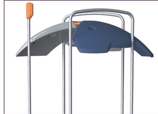
Los techos ELEMENTS están hechos de PE reciclable con un espesor de pared mínimo de 5mm para garantizar una alta durabilidad en todos los climas del mundo. Los postes de acero están galvanizadas en caliente por dentro y por fuera para una máxima durabilidad.
