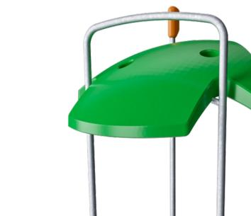
Střechy řady ELEMENTS jsou vyrobeny z recyklovatelného PE z 33 % tvořeného post-spotřebními materiály s minimální tloušťkou stěny 5 mm, aby byla zajištěna vysoká životnost ve všech klimatických podmínkách po celém světě. Ocelové trubky jsou žárově zinkované uvnitř i vně, aby byla zajištěna maximální životnost.
