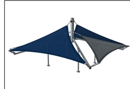
Plachty z komerčního vysokohustotního 95 PE, pléténé speciálně pro struktury chránící před sluncem. Plachty jsou ošetřeny UV stabilizátory pro zajištění dlouhé životnosti. Plachty jsou podepřeny žárově zinkovaným ocelovým rámem a napnuté nerezovými součástkami.
