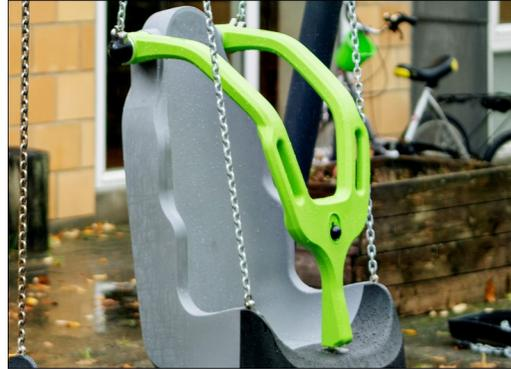
Der Bügel besteht aus geformtem, recycelbarem Polyethylen (PE) mit einem Post-Consumer-Materialanteil von 33 %. Der Bügel ist mit einer Torsionsfeder aus Edelstahl ausgestattet, die den Bügel in jeder Position hält, um dem Benutzer das Ein- und Aussteigen zu erleichtern. Der Bügelverschluss ist mit einem einhändig bedienbaren Schieber aus Edelstahl ausgestattet.
