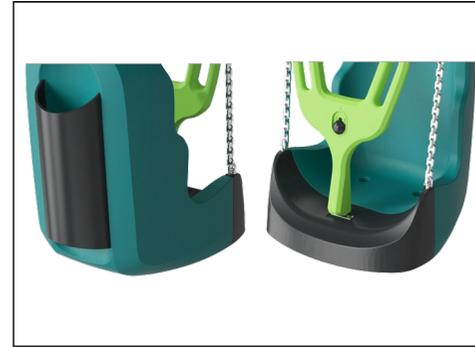
Der vordere Stoßdämpfer besteht aus einem Kern aus starkem Polypropylen (PP) mit einer weicheren Außenschicht aus thermoplastischem Gummi (TPE) und der hintere Stoßdämpfer aus einer 8 mm dicken EPDM-Membran. Die weichen, stoßabsorbierenden Dämpfer mit rutschfester Oberfläche machen den Schaukelsitz extrem sicher in der Benutzung.
