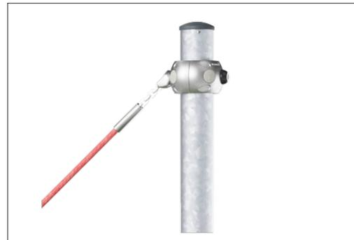
Les pinces intelligentes Corocord sont soigneusement conçues dans les moindres détails pour assurer une flexibilité supérieure dans un matériau en aluminium de haute qualité. Les pinces intelligentes sont fixées autour des poteaux avec quatre boulons en acier. Les points d'attache non utilisés sont fermés par des capuchons en polyamide (PA).
