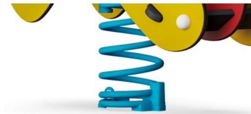
Los muelles KOMPAN están hechos de acero de resorte de alta calidad según EN10270. Los muelles se limpian mediante fosfatación antes de pintarlos con una imprimación epoxi y un recubrimiento de poliéster en polvo como acabado superior. Los muelles se fijan mediante accesorios anti-pelliczos únicos para máxima seguridad y larga vida útil.
