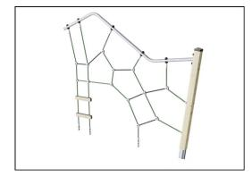
Corocord-Seile aus UV-stabilisierten PES-Seilsträngen mit innerer Stahlseilverstärkung. Das Polyestergarn wird aus +95 % Post-Consumer-Materialien hergestellt und induktiv auf jede Litze aufgeschmolzen. PES hat eine hohe Festigkeit mit ausgezeichneter Beständigkeit gegen Abrieb und UV-Strahlung. Die Seile sind mit S-Klemmen aus Edelstahl verbunden.
