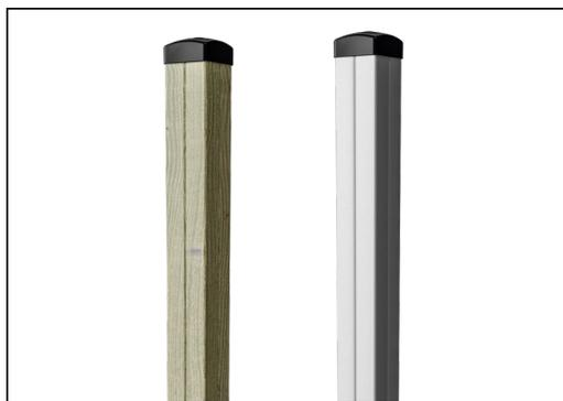
Deux types de matériaux sont disponibles pour les poteaux de la tour principale : Poteaux en bois de pin Européen de classe 3, imprégné avec traitement au Tanalith E3475 conformément à la norme EN 335. Poteau en aluminium d'épaisseur 2 mm avec traitement de surface anodisé. Aluminium EN AW-6060 T66.
