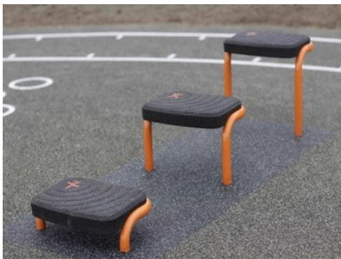
Le cadre porteur est fait d'acier carbon de Ø48,3mm x 4 mm, avec une surface galvanisée par immersion à chaud conforme à la norme ISO1461, et un revêtement de poudre anti corrosion de classe C3 selon la norme ISO12944-2. La teneur en plomb des surfaces est inférieure à 90 ppm.
