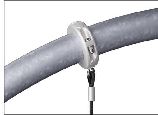
Corocord 铝夹是钢柱和绳索之间的连接配件。两个铝铸件用螺栓固定在一起。因此，夹具的高度是可调整的。
