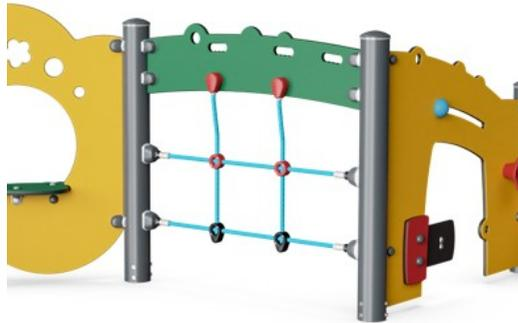
Seile aus UV-stabilisierten PES-Seilsträngen mit innerer Stahlseilverstärkung. Das Polyestergerüst wird aus +95 % Post-Consumer-Materialien hergestellt und induktiv auf jede Litze aufgeschmolzen.
