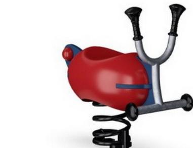
Les ressorts KOMPAN sont fabriqués en acier de haute qualité selon la norme EN 10270. Les ressorts sont nettoyés par phosphatation, avant d'être peints avec une amorce époxy et un revêtement thermolaqué de polyester en guise de finition. Les ressorts sont fixés par des raccords anti-pincement uniques pour une sécurité maximale et une longue durée de vie.
