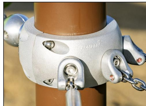
I morsetti intelligenti Corocord sono attentamente progettati in materiale di alluminio di alta qualità per garantire un'elevata flessibilità. I morsetti intelligenti vengono fissati attorno ai montanti con quattro bulloni in acciaio. I punti di fissaggio non utilizzati vengono chiusi con coperture in poliammide (PA).
