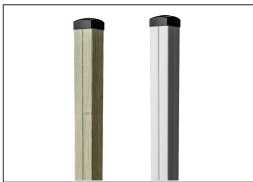
主塔柱有两种类型的材料：欧洲松木柱，根据 EN335 标准，木材用 Tanalith E3475 标准进行 3 级压力浸渍（相当于 NTR AB 级）。铝柱 t = 2mm，经阳极氧化表面处理。基础材料 EN AW-6060 T66。
