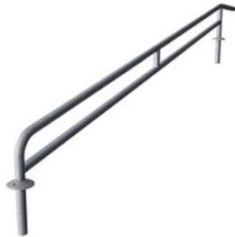
La altura de la barandilla es de 930 mm y la distancia entre la barandilla es de 900 mm. El material utilizado para la barandilla es acero galvanizado en caliente de 38 mm, un gran diámetro para un buen agarre y soporte para las muñecas.
