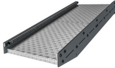
La rampa está montada bajo un ángulo de 15 grados y tiene una longitud de 2300 mm. La rampa está hecha de una placa de aluminio de 5 mm con un patrón antideslizante.
