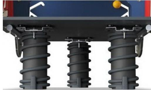
Los muelles KOMPAN están hechos de acero de resorte de alta calidad según EN10270. Los muelles se limpian mediante fosfatación antes de pintarlos con una imprimación epoxi y un recubrimiento de poliéster en polvo como acabado superior. Los muelles se fijan mediante accesorios anti-pellizcos únicos para máxima seguridad y larga vida útil.
