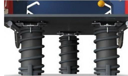
Los muelles se fijan mediante accesorios anti-pellizcos únicos para máxima seguridad y larga vida útil. Los resortes tienen un inserto PUR para estabilizar el muelle.
