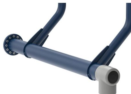
L'arbre d'entrée est en acier galvanisé à chaud Ø101,3 x 2,9 mm S355 et enduit de poudre. Le logement du roulement est en aluminium moulé (EN AB-44100 / EN AB-AISI12(a)) avec des roulements à billes scellés à alignement automatique. Une construction extrêmement solide et durable.
