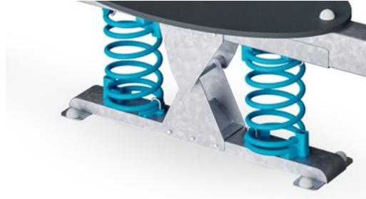
KOMPAN 弹簧由符合 EN10270 的优质弹簧钢制成。弹簧通过磷化处理进行清洁，然后将其涂上环氧底漆和聚酯粉末涂料作为上光油。弹簧通过独特的防夹配件固定，以实现最大的安全性和较长的使用寿命。
